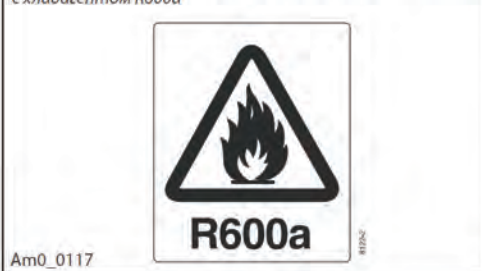
Рис. 6. Этикетка на компрессоре, работающем с хладагентом R600a
