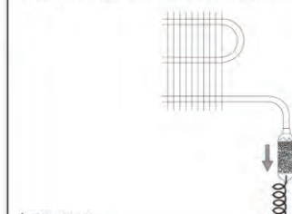
Рис. 10. Правильная установка фильтра-осушителя
